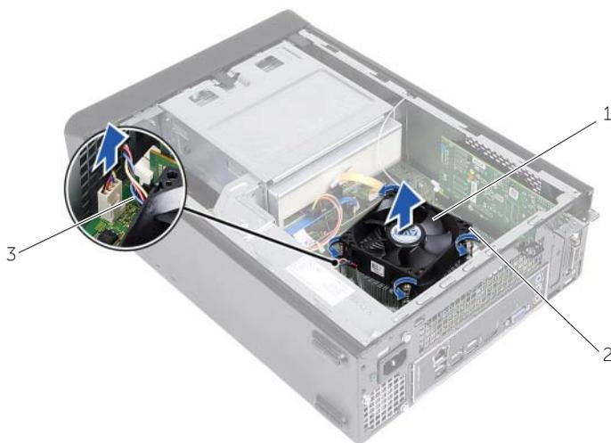
1 gruppo ventola del processore e dissipatore di calore
