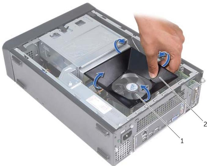
1 gruppo ventola del processore e dissipatore di calore
